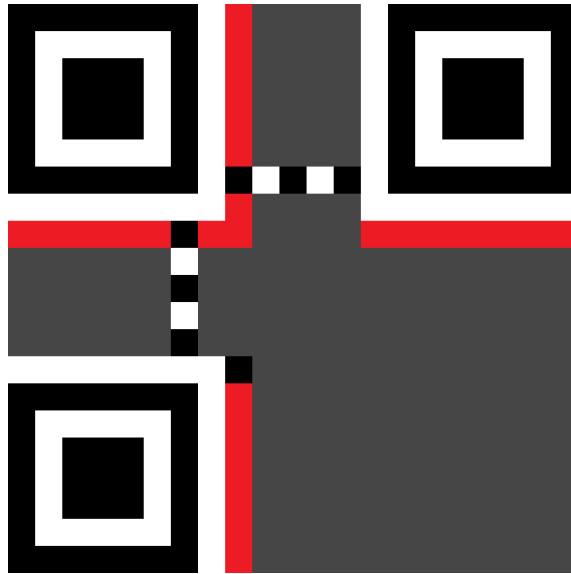
Figur 2: Efter att vi ritat ut våra fasta mönster ser koden ut såhär. Det röda fältet är reserverat för formatinformationen, som vi diskuterar i ett framtida kapitel.
